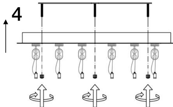
Retirar la pieza de plástico y desplazar la conexión al interior del plafón
